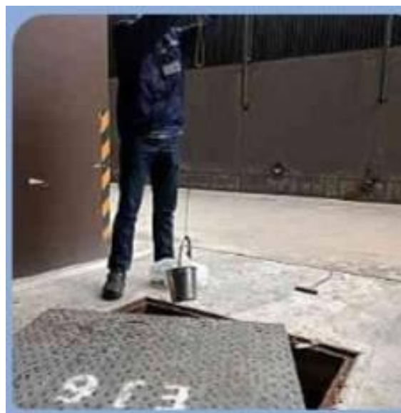
รูปที่ 3.5.1-1 การเก็บตัวอย่างคุณภาพน้ำทิ้ง
