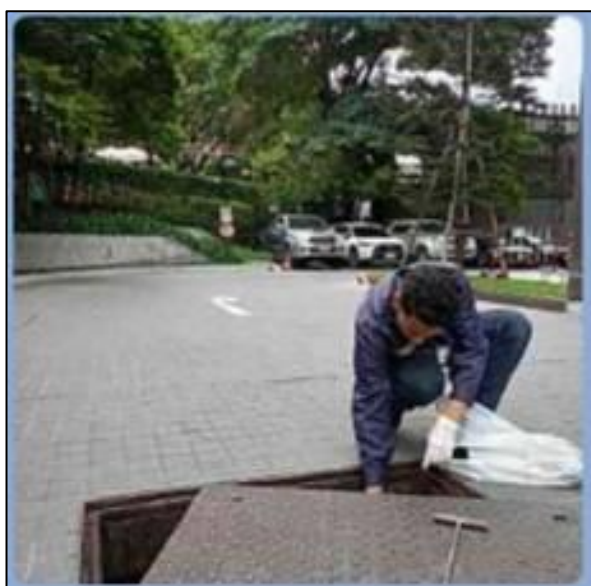
รูปที่ 3.5.1-1 การเก็บตัวอย่างคุณภาพน้ำทิ้ง
